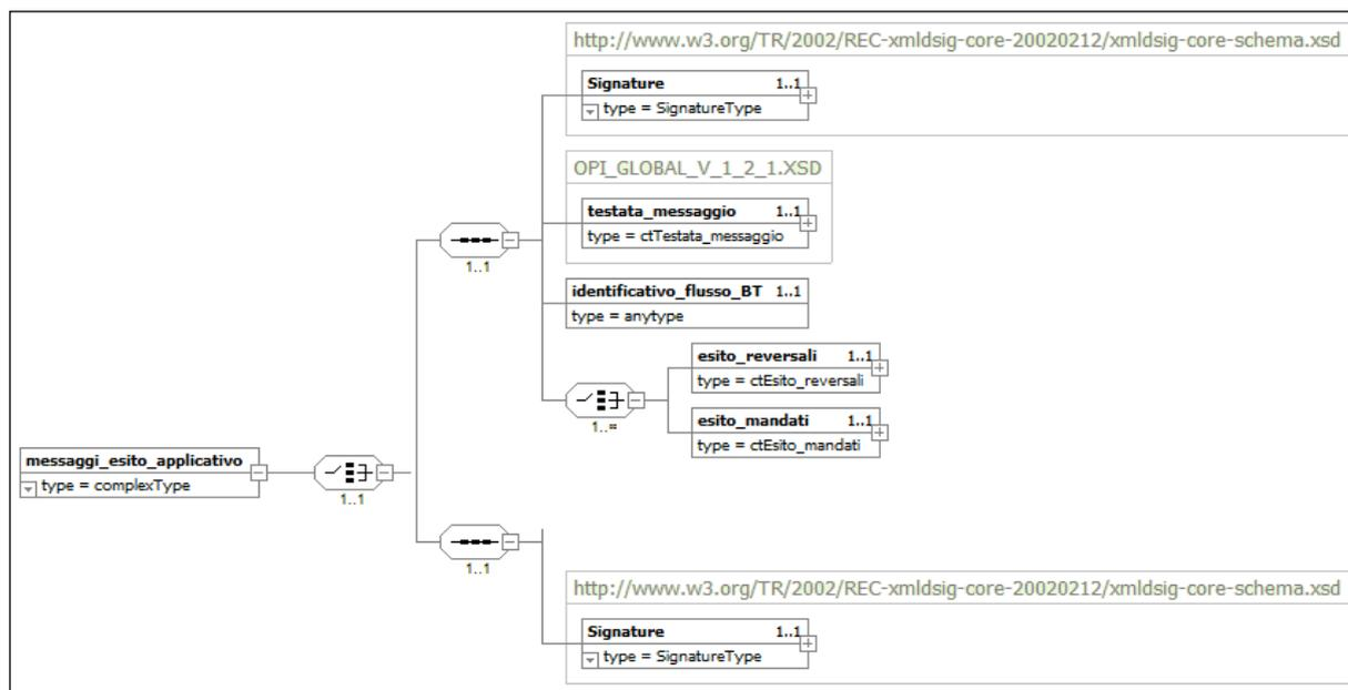
**Figura 19 - Struttura del messaggio di esito applicativo**
