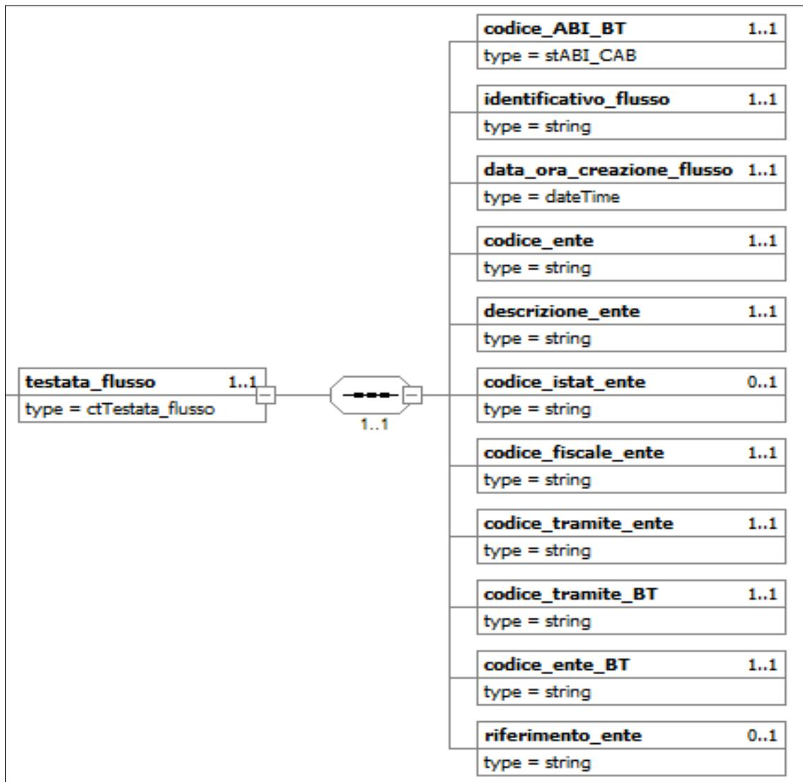
**Figura 6 - Schema grafico della testata del flusso degli ordinativi**
