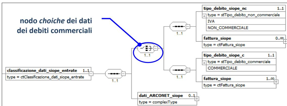
Figura 16 - Schema grafico della struttura **<classificazione\_dati\_siope\_entrare>**
