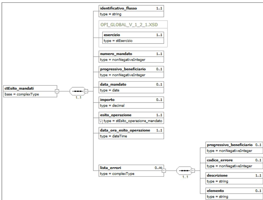
Figura 20 - Struttura dell'elemento &lt;esito\_mandati&gt;
