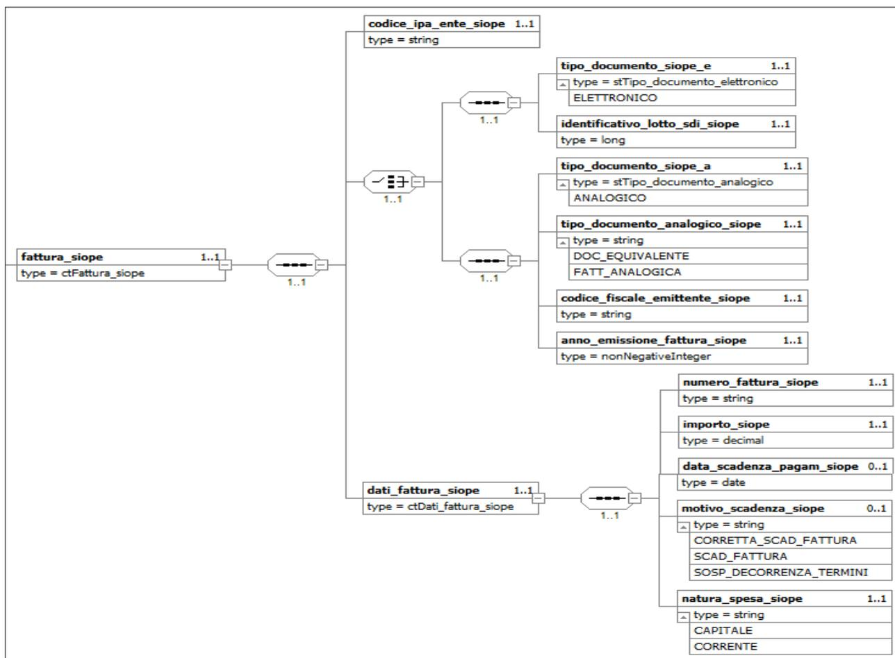
Figura 7 - Schema grafico della struttura **<fattura>**
