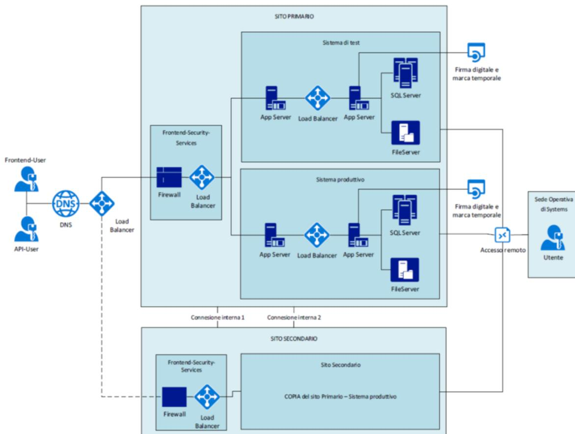
Figura 9: Schema dell'architettura del sistema di conservazione
