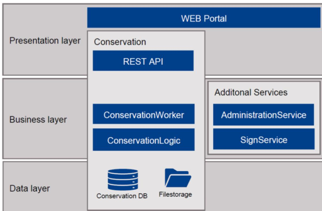
Figura 8: Architettura del Sistema di Conservazione
