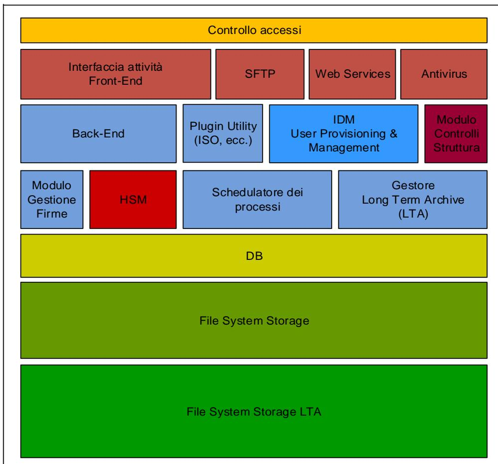
**Figura 12 Componenti del Sistema di conservazione Strongdox**
