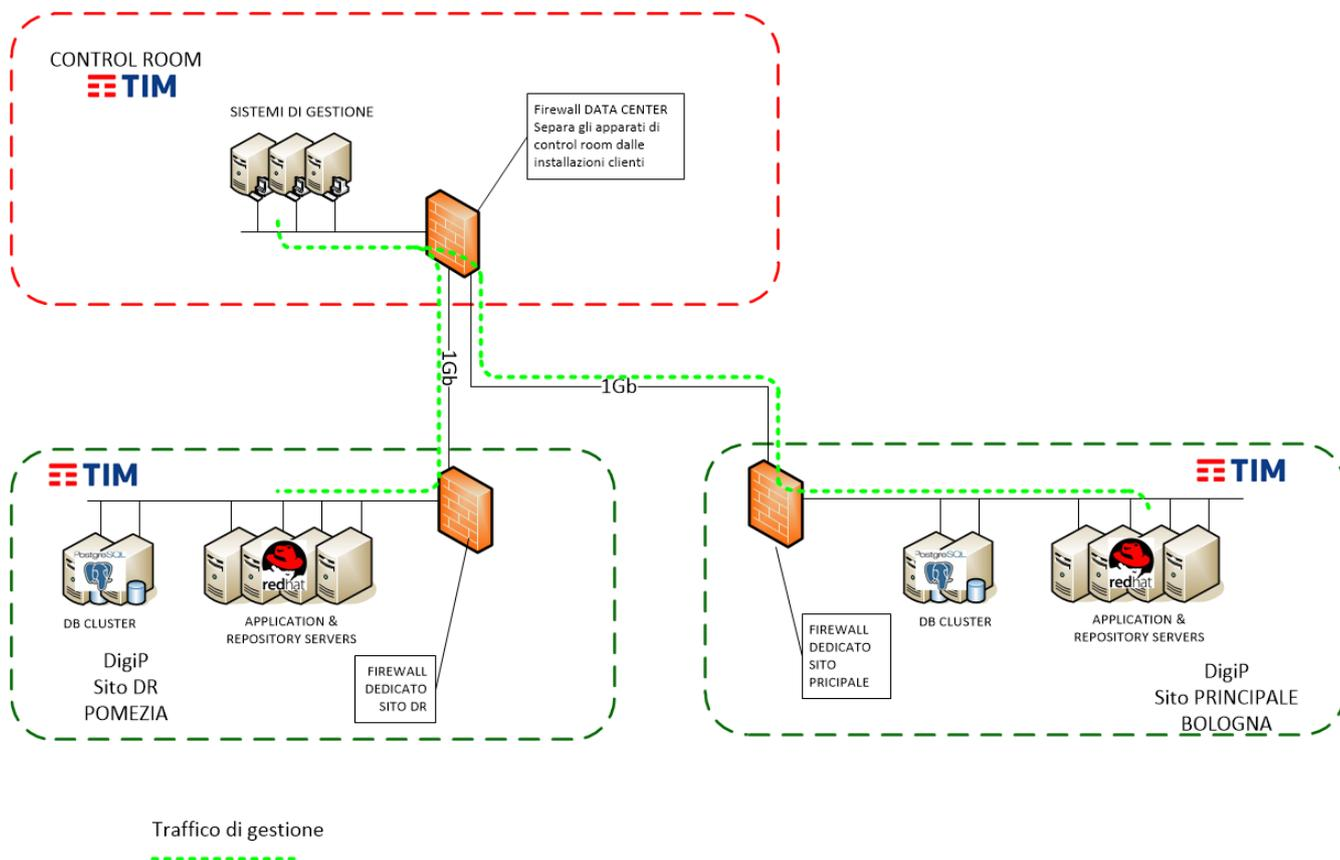
Figura 10 - Modalità di connessione Control Room a DigiP
