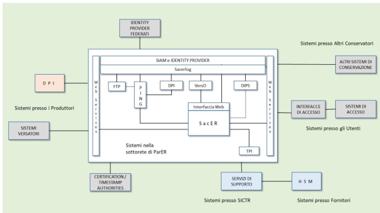
**Figura 9 - Schema Tecnologico del Sistema di conservazione**
