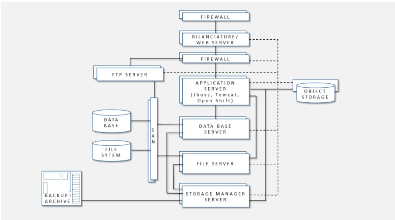
**Figura 12 - Schema del Sito Primario**
