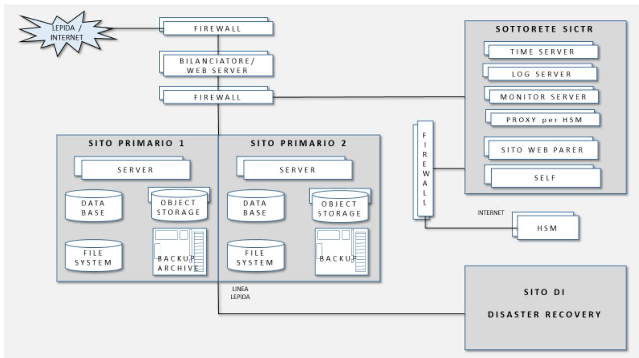
**Figura 11 - Schema dei Sistemi di ParER**
